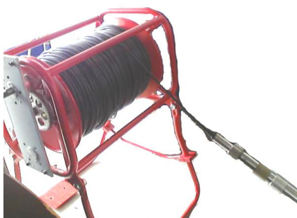
接收探头与绞车连接示意图
