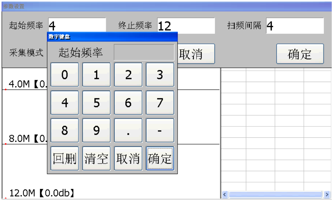
图：设置为起始频率 4MHz, 终止频率 12MHz, 扫频间隔 4MHz, 可同时完成三个频率点检测。其他操作与点频方式一致。
