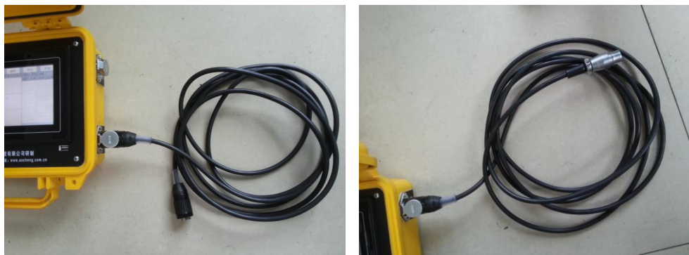
图：发射、接收口同时连接发射和接收探头
